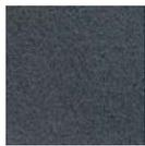
**Gris 746:** Fabricada con granos de carburo de silicio en grano medio. Por su capacidad de corte muy agresivo, es ideal para operaciones de limpieza profunda.
