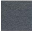
**Gris 635:** Fabricada con carburo de silicio en grano ultra fino. Por su composición remueve rebabas en plástico, brinda mejores acabados en pintura, desgasta superficies de acrílico y da acabado en piezas de aluminio. Ideal para acabados, matizados y asentamiento de superficies.
