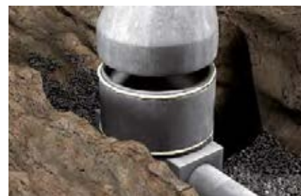
Sellado de tapas de aguas servidas en hormigón
