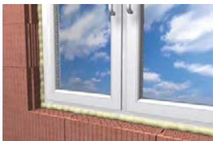
Juntas en instalación de aberturas
