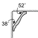
Cuando se han de cortar listones/matrices para cielorrasos colocados planos sobre la mesa de corte, se deben configurar los ángulos de inglete estándar de  $31,6^\circ$  (horizontal) y  $33,9^\circ$  (vertical). La siguiente tabla contiene instrucciones para cortar listones/matrices para pisos.
