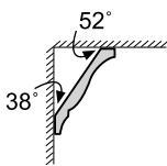
Quando as tiras/ moldes do teto forem serradas rente à mesa da serra, os ângulos de corte padrões de  $31,6^\circ$  (horizontal) e  $33,9^\circ$  (vertical) devem ser instalados. A seguinte tabela contém as instruções dos moldes/ tiras para serrar tetos.
