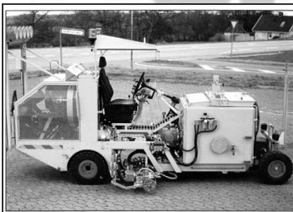
La **proyección neumática** combina aire y material termoplástico fundido bajo presión, depositándolo sobre el pavimento. Durante la aplicación en “Spray” (normalmente, en 1.5 mm de espesor) o “Extrusión a presión” (normalmente, 2.3 mm) asegúrese de lo siguiente:
