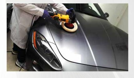
Los pads de cordero compuestos de lana 100% natural poseen un corte alto y son utilizados para el pulido de pinturas automotor.
