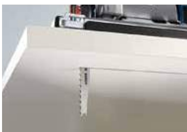
La T 308 BF es idónea para trabajar materiales de tablero de alta calidad plastificados por ambos lados (grosor de capa mín. 0,7 mm).
