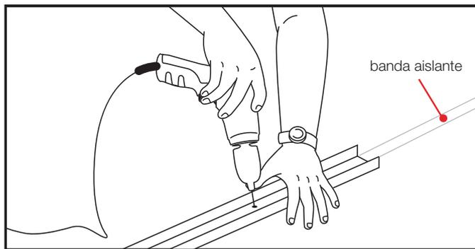
03 // Colocar la banda aislante en los montantes de arranque y final junto con la fijación de los mismos a la pared. Luego los intermedios, con una separación de 40 cm si el emplacado es vertical, o de 48 cm si el mismo es horizontal.
