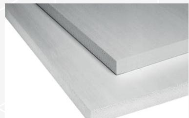
La estructura celular totalmente cerrada del poliestireno extruido le proporciona sus excelentes prestaciones frente a la absorción de agua y como aislante térmico. La elevada rigidez de la estructura celular dada por la gran homogeneidad de las celdas proporciona, a su vez, una altísima capacidad de resistencia mecánica.
